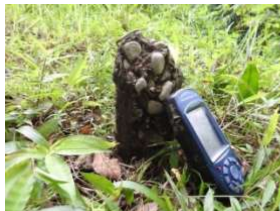
Gambar 3. Contoh Kondisi Pal Batas yang Baik dan Rusak
